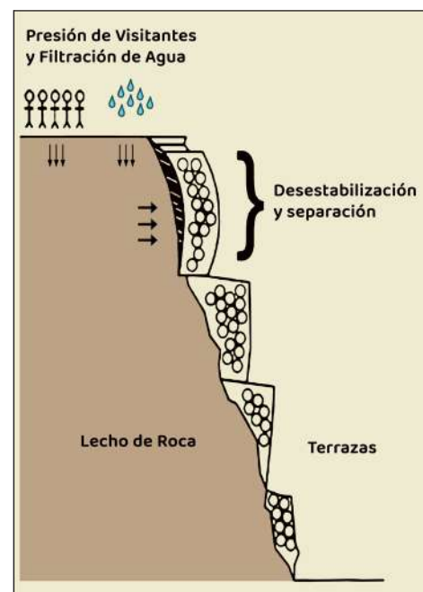
Clima lluvioso, situación del sustrato y potencial sobrecarga desestructuran los muros y causan pandeo. Fuente: Estudio Comer
